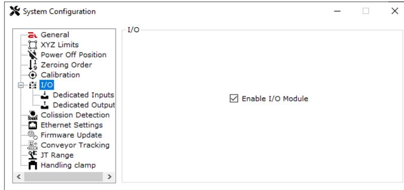
Er erlaubt auch, dass bestimmte Eingänge oder Ausgänge zur Erfüllung der vorbestimmten Funktion, wie z. B. Motor ON, dediziert werden.
