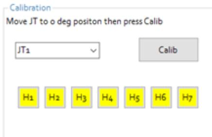
Diese Sektion erlaubt dem Nutzer den Roboter zu kalibrieren und auch magnetische Sensoren, die an allen Achsen installiert sind, zu prüfen. Wenn die Taste mit Hx-Bezeichnung, wo x von 1 bis 7 beträgt, gelb leuchtet, sieht der Magnetsensor den Magnet.
