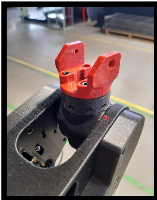
Das Befestigungselement muss an den Roboterflansch mithilfe von Zylinderschrauben M3x8 angeschraubt werden.
