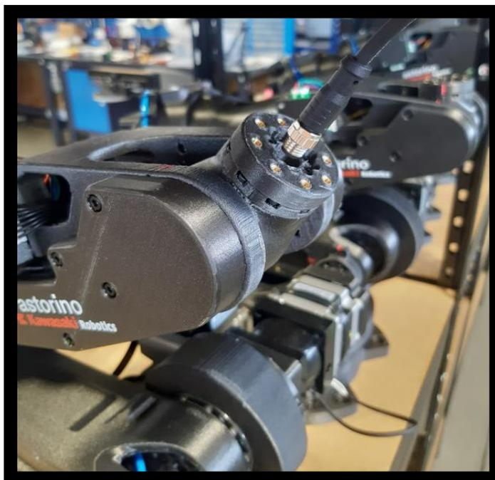
Die Leitung soll vom Greifer durch die 6. Achse und den Arm der 4. Achse geführt werden.
